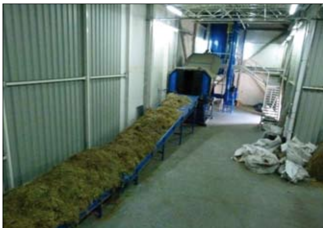
Fot. 2. Hala przygotowania słomy - na pierwszym planie stół podawczy
