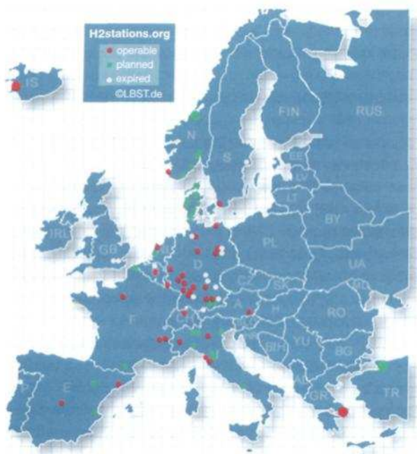
Rys. 2. Zestawienie pracujących, planowanych i wyłączonych stacji napełniania wodorem w Europie (Ludwig-Bölkow-Systemtechnik & Blandow 2007)
