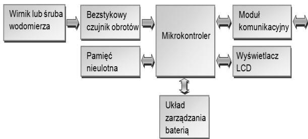
Rys. 3. Schemat wodomierza z licznikiem elektronicznym
