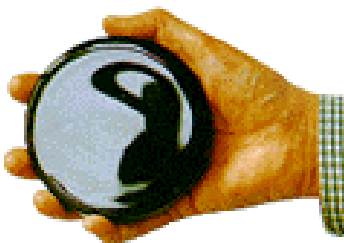
Rys. 6. Ilość odpadów wysokoaktywnych odpowiadająca zużyciu energii elektrycznej dla potrzeb człowieka w całym jego życiu
