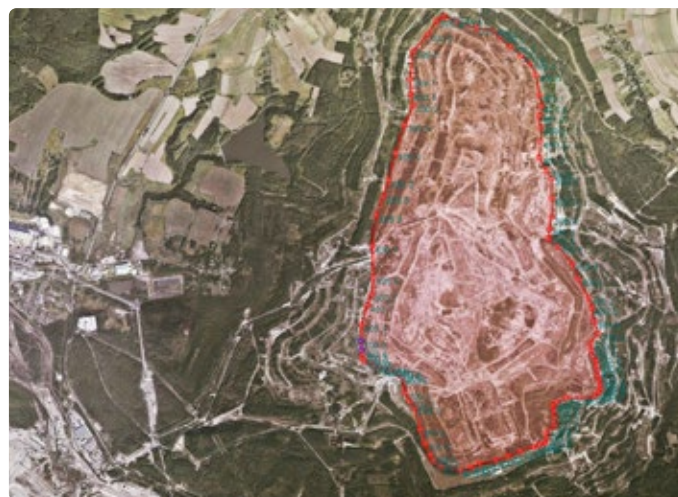
Rys. 3. Proponowana lokalizacja górnego zbiornika. Poziom dna zbiornika na rzędnej 400 m n.p.m., zaznaczona powierzchnia wynosi 657,58 ha
