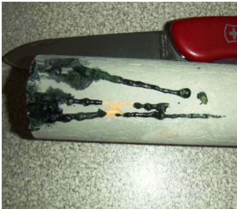
Rys. 2. Osad na aparaturze pomiarowej po kilkudniowej eksploatacji w kanale spalin
