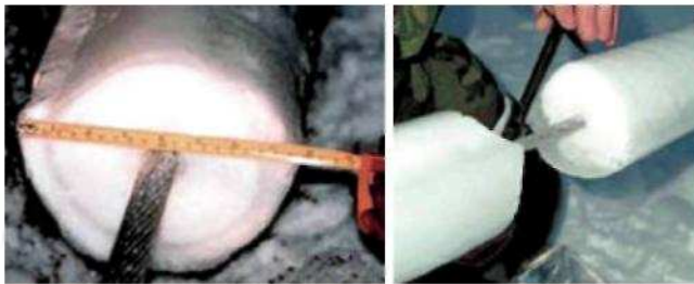
Rys. 7. Największa zaobserwowana średnica oblodzenia równa 19,7 cm [4]
